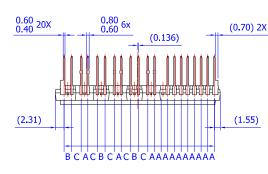
LEAD PITCH (TOLERANCE : ±0.30) A : 1.778 B : 2.050 C : 2.531
