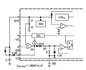
Figure 24. Soft-Start Circuit
