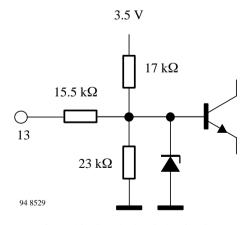
Figure 13. Standard switch (pin 13)
