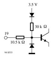
Figure 17. AFC switch (pin 19)
