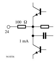
Figure 20. Intercarrier output (pin 24)
