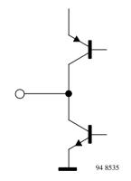
Figure 19. AFC output (pin 22)
