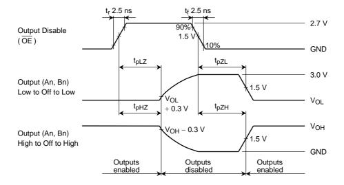
$\textbf{Figure 3} \quad t_{\text{pLZ}},\, t_{\text{pHZ}},\, t_{\text{pZL}},\, t_{\text{pZH}}$
