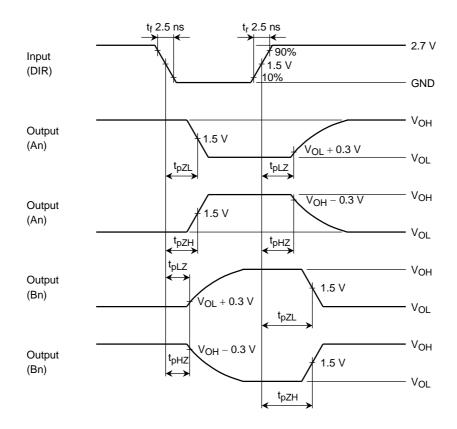
Figure 4 t<sub>pLZ</sub>, t<sub>pHZ</sub>, t<sub>pZL</sub>, t<sub>pZH</sub>
