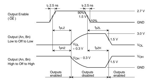
$\textbf{Figure 3} \quad t_{\text{pLZ}}, \, t_{\text{pHZ}}, \, t_{\text{pZL}}, \, t_{\text{pZH}}$
