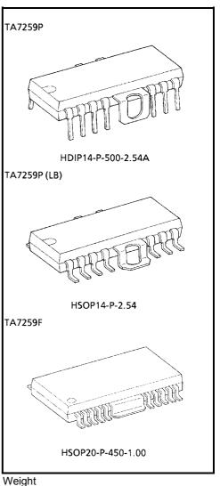
HDIP14-P-500-2.54A : 3.00 g (Typ.) HSOP14-P-2.54 : 3.00 g (Typ.) HSOP20-P-450-1.00 : 0.79 g (Typ.)
