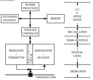
Figure 1-1. IEEE 802.4 Token Bus Carrier Band Node
