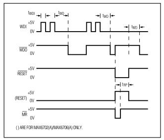
Figure 7. MAX6701(A)/MAX6702(A)/MAX6703(A)/MAX6705(A)/MAX6706(A)/MAX6707(A) Watchdog Timing
