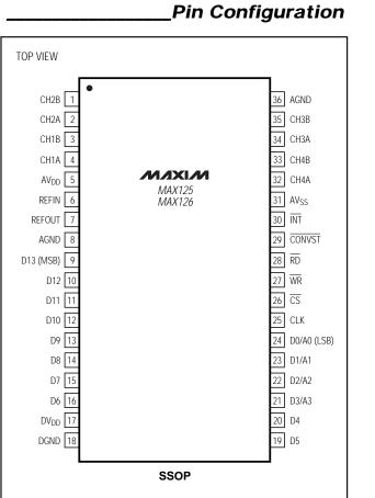
CH1A CH1B D0/A0 CH2A D1/A1 CH2B D2/A2 CH3A D3/A3 CH3B D4 /VI/IXI/VI CH4A D5 MAX125 CH4B D6 MAX126 D7 +5V -D8  $AV_{DD}$ T D9 0.1µF \_ D10 AGND D11 0.1µ.F ÷ D12 -5V AV<sub>SS</sub> D13 REFIN +5V  $\mathsf{DV}_\mathsf{DD}$ 0.1µF 0.1µF REFOUT DGND 4.7µF ς. CONVST INT ĊŚ RD WR CLK 16MHz CONTROL INTERFACE
