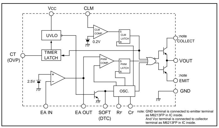
GENERAL PURPOSE HIGH SPEED PWM CONTROL IC
