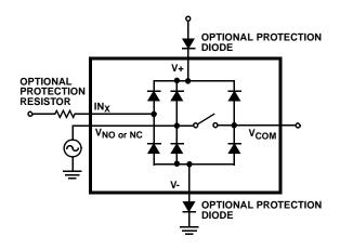
FIGURE 8. OVERVOLTAGE PROTECTION
