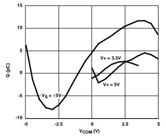
FIGURE 12. CHARGE INJECTION vs SWITCH VOLTAGE
