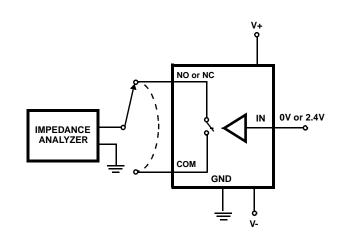
FIGURE 7. CAPACITANCE TEST CIRCUIT
