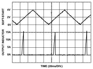
FIGURE 4. OVER-CURRENT OPERATION
