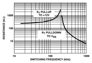
FIGURE 1. RT RESISTANCE vs FREQUENCY
