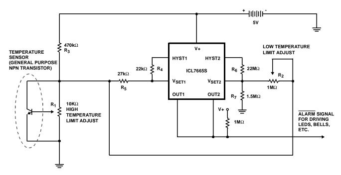
FIGURE 16. SIMPLE HIGH/LOW TEMPERATURE ALARM
