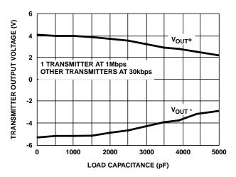
FIGURE 15. TRANSMITTER OUTPUT VOLTAGE vs LOAD CAPACITANCE
