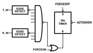
FIGURE 7. ENHANCED AUTOMATIC POWERDOWN LOGIC
