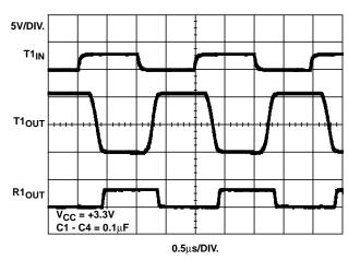
FIGURE 14. LOOPBACK TEST AT 1Mbps (C<sub>L</sub> = 250pF)
