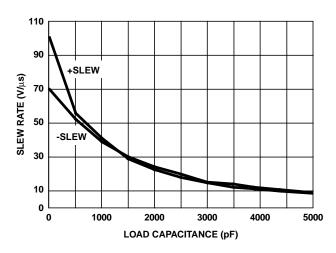
FIGURE 16. SLEW RATE vs LOAD CAPACITANCE
