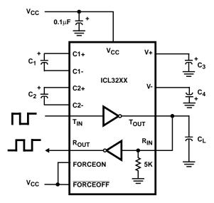
FIGURE 12. TRANSMITTER LOOPBACK TEST CIRCUIT
