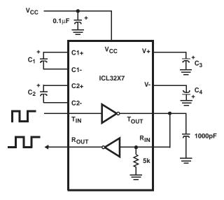
FIGURE 7. TRANSMITTER LOOPBACK TEST CIRCUIT
