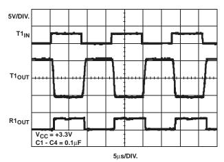
FIGURE 8. LOOPBACK TEST AT 120kbps
