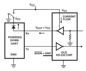
FIGURE 2. POWER DRAIN THROUGH POWERED DOWN
