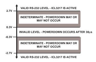
FIGURE 4. DEFINITION OF VALID RS-232 RECEIVER LEVELS
