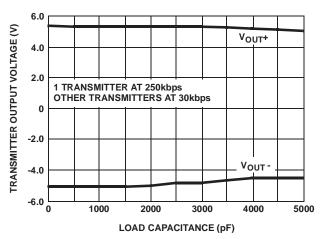
FIGURE 10. TRANSMITTER OUTPUT VOLTAGE vs LOAD CAPACITANCE
