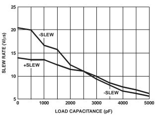
FIGURE 11. SLEW RATE vs LOAD CAPACITANCE
