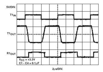
FIGURE 9. LOOPBACK TEST AT 250kbps
