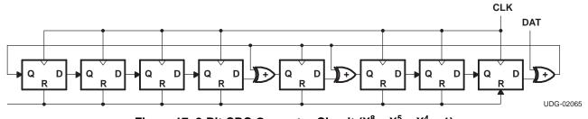
Figure 17. 8-Bit CRC Generator Circuit  $(X^8 + X^5 + X^4 + 1)$
