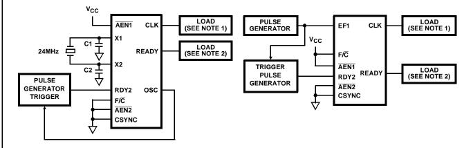
FIGURE 7. TRYLCL, TRYHCH LOAD CIRCUITS
